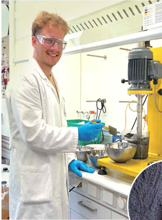
6월 10일, 알토대 광물처리학과 연구실에서는 사용후배터리를 분쇄한 뒤 남은 가루인 '블랙매스(오른쪽 사진)'를 분리하는 플로테이션 실험이 한창이었다. 대학원생인 루이스 연구원이 해맑게 웃고 있다.
