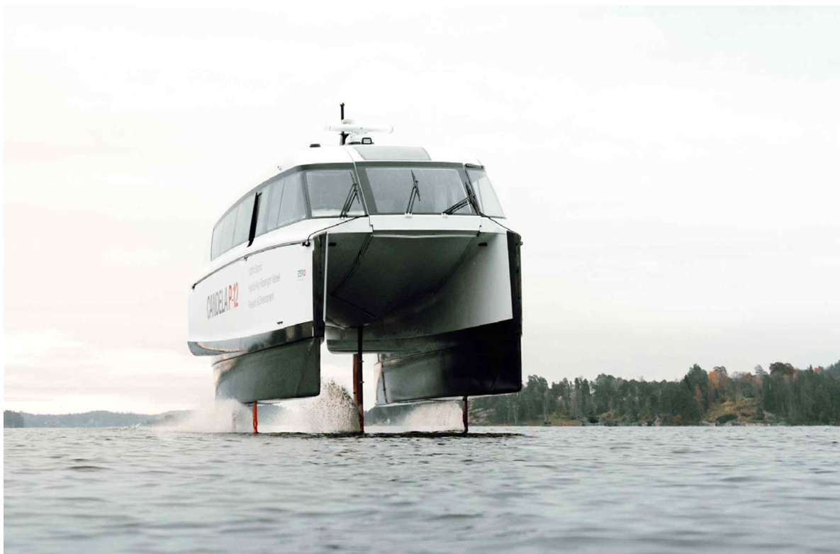
스웨덴의 전기배 기업 '칸델라'에서 개발한 전기 수중익선 P-12가 스톡홀름 군도를 누비고 있다. 선체를 물 위로 띄운 채 항해하는 '수중익 모드'를 통해 물과 마찰해 발생하는 에너지 손실을 줄인다. 항해 시 발생하는 파도 크기가 일반 배보다 작은 것도 특징이다.
