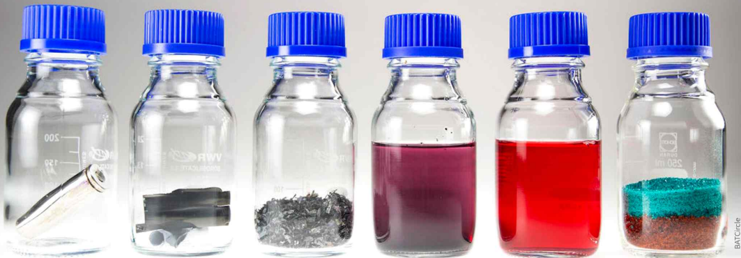
핀란드의 배터리 연구 협력 프로젝트 ‘BATCircle’에서는 왼쪽의 사용후배터리를 분해해, 물리·화학적 방법으로 다시 원료 물질을 분리한 뒤, 제일 오른쪽 단계에까지 이르게하는 전 과정을 연구하고 있다.
